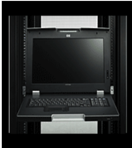
Figura 5.10: Consola de sistema de servidores
