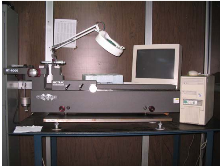
Figura 1.11. Estación de medición unidimensional.
