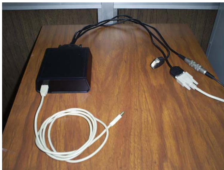
Figura 3.3. Conexión de la tarjeta electrónica USB con la estación de medición unidimensional.
