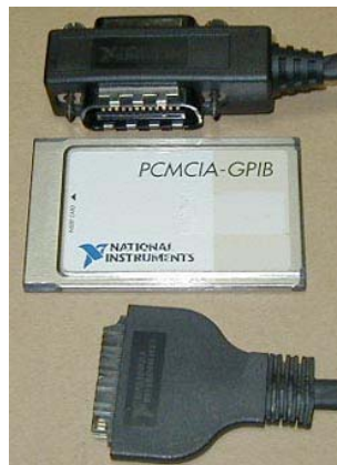
Figura 2.6. Tarjeta GPIB-PCMCIA de intercambio de protocolos IEEE-488.
