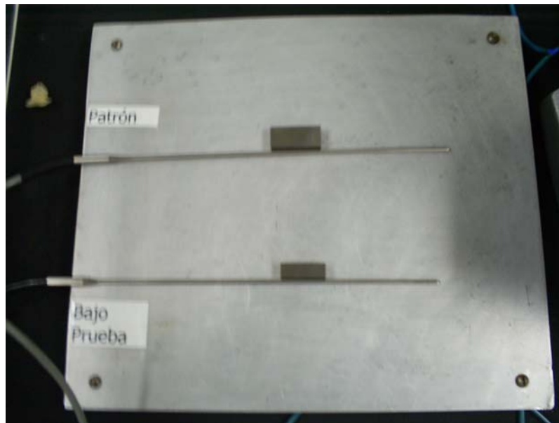
Figura 2.2. Medición de temperatura con el termómetro de resistencia de platino.
