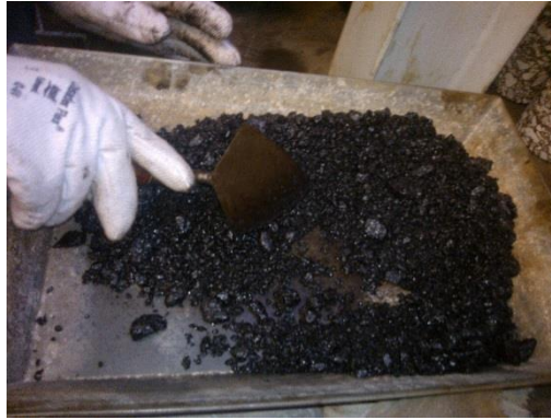
Figura 3.23 Charola en donde se enfría la mezcla asfáltica.
