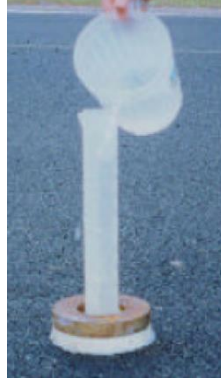
Figura 2.5 Modificación del permeámetro NCAT (Cooley, et al 1999)
