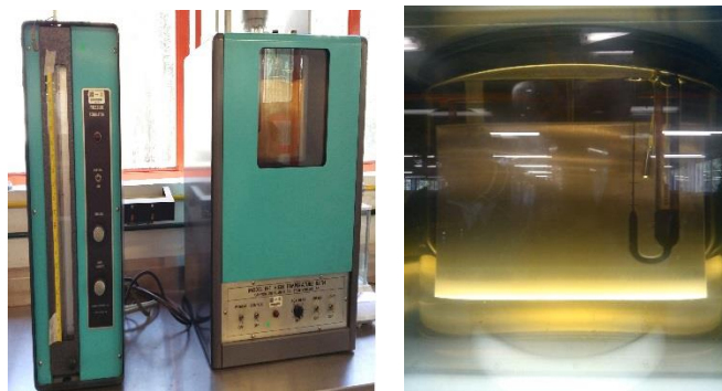
Figura 3.12 Ensayo de la viscosidad cinemática
