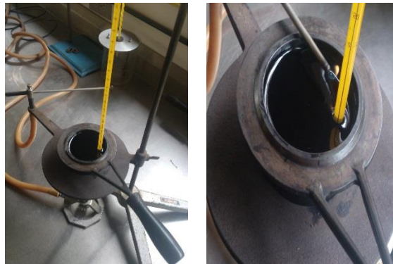
Figura 3.16 Ensayo de punto de inflamación
