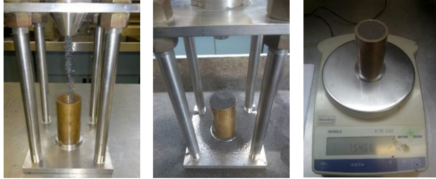
Figura 3.4 Equipo para contenido de vacíos no compactados de agregado fino
