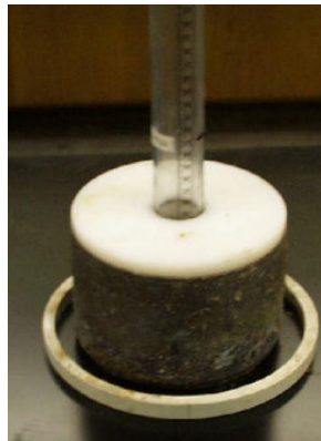
Figura 2.6 Permeámetro molde de Marshall – sello de parafina (Cooley, et al. 1999)
