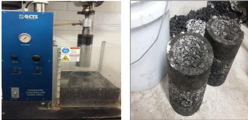
Figura 3.29 Extracción de núcleos de concreto asfáltico
