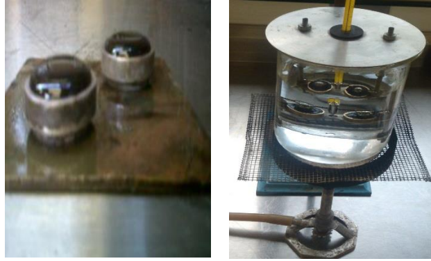
Figura 3.15 Ensayo de punto de reblandecimiento
