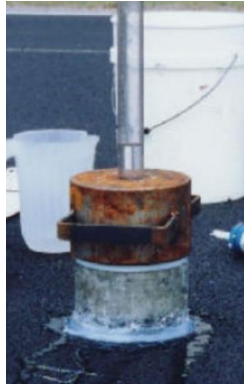
Figura 2.7 Permeámetro molde de Marshall – sello de silicón (Cooley, et al. 1999)
