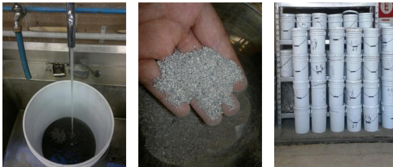
Figura 3.2 lavado, cribado y almacenamiento del material
