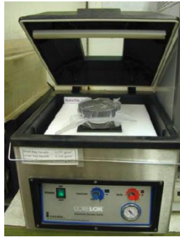
Figura 2.10 Dispositivo Corelok (Cooley, et al 2002)
