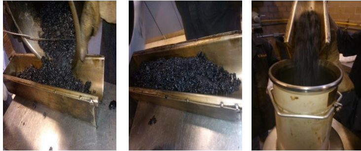
Figura 3.26 Llenado de molde para compactar mediante una cuneta.
