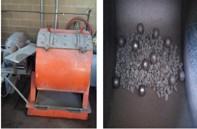
Figura 3.7 Máquina de Abrasión de los Ángeles
