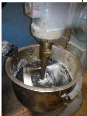
Figura 3.22 Homogenización en una mezcladora mecánica
