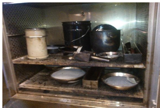
Figura 3.25 Condicionamiento de equipo para mezclar, compactar y agregado pétreo
