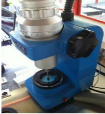
Figura 3.17 Reómetro de corte dinámico
