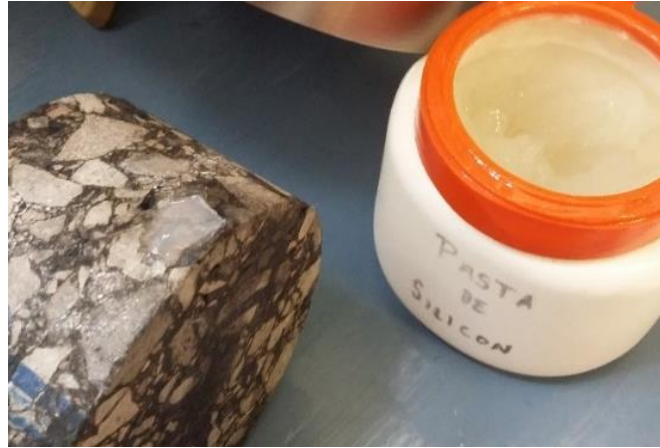
Figura 3.33 Recubrimiento lateral con pasta de silicón
