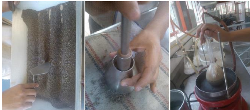
Figura 3.10 Procedimiento para gravedad específica de agregados finos (Josephia R., 2015)
