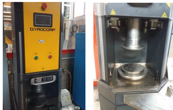
Figura 3.27 Compactador giratorio SUPERPAVE
