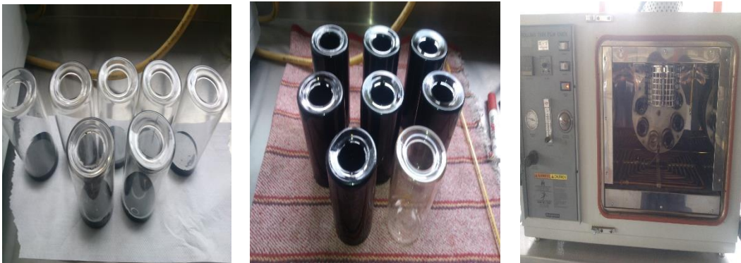
Figura 3.18 Ensayo de película fina en horno rotatorio
