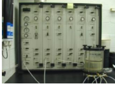
Figura 2.9 Permeámetro carga constante (Maupin, 2000)
