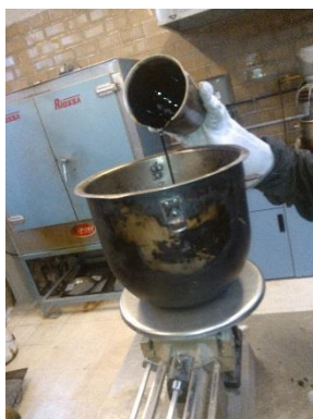
Figura 3.21 Vaciado de cemento asfáltico sobre agregado pétreo
