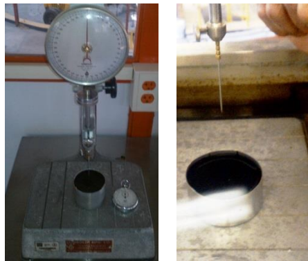
Figura 3.14 Ensayo de penetración del cemento asfáltico
