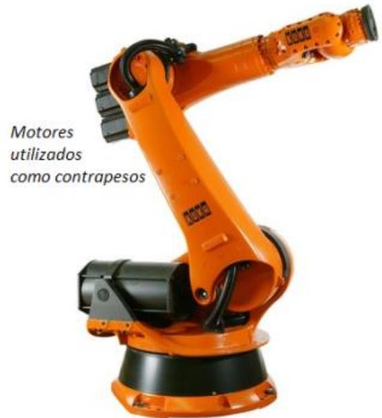
Figura 2.2 Robot KUKA balanceado con las masas de los motores
