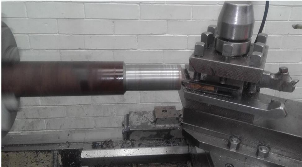
Figura 4.5 Cilindrado de la barra de acero
