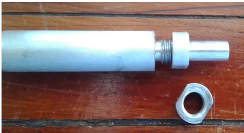
**Figura 4.4 Flecha y tuerca que une a los eslabones que forman el antebrazo del robot.**
