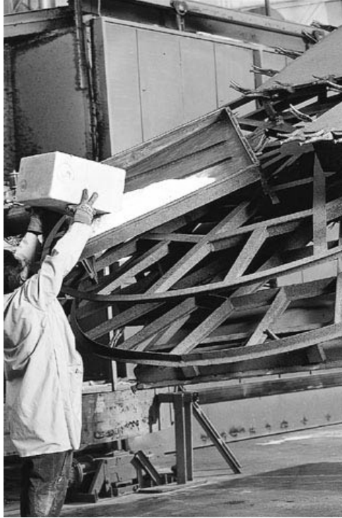
Figura 1.2 Carga de material plástico en polvo al molde, el cual ya se encuentra colocado en la araña (imagen tomada de Gold Shield Inc.)
