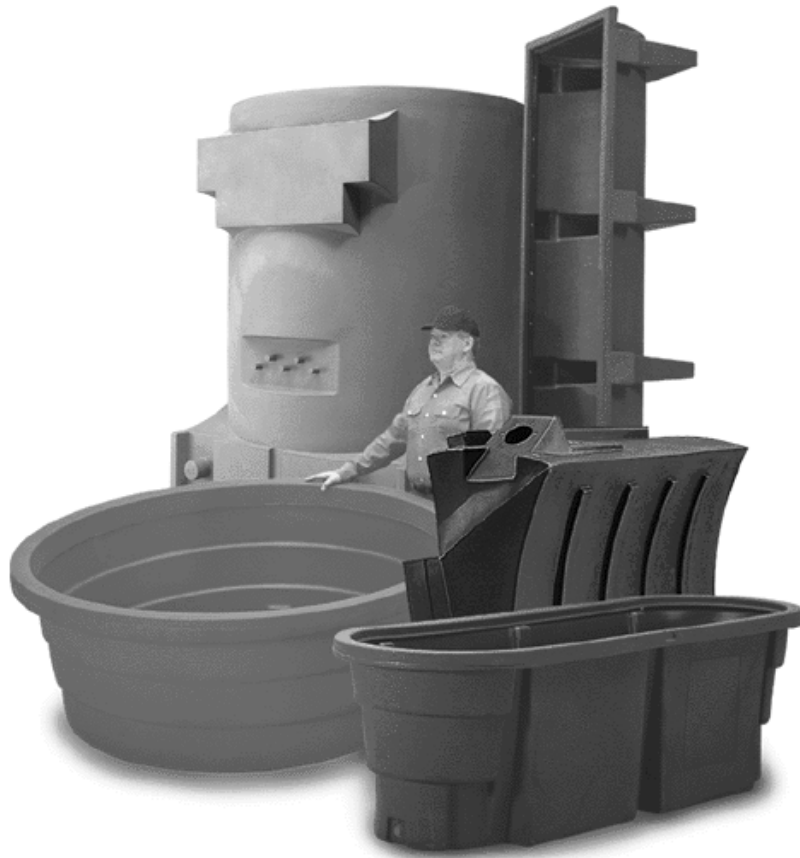
Figura 4.2 Piezas de tamaños grandes fabricadas por rotomoldeo, para este tipo de piezas es necesario reforzarlas para evitar deformaciones (de Ameri-kart Advantages).
