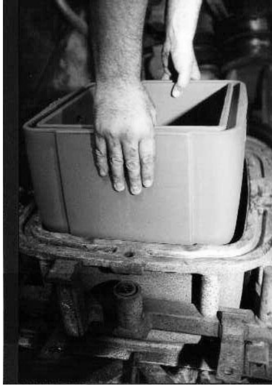
Figura 4.10 Desmolde de una pieza plástica de polietileno de alta densidad sin problemas, a pesar del alto factor de contracción se aplicó en su diseño un ángulo de salida.
