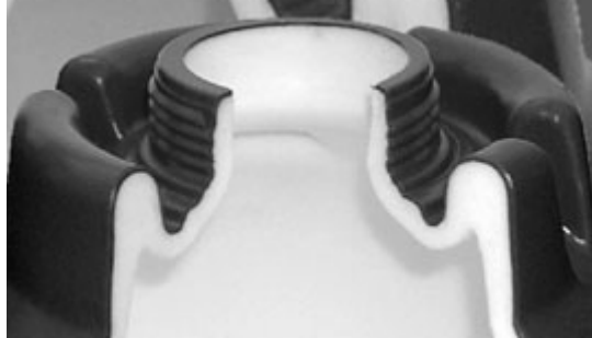
Figura 4.13 Pieza rotomoldeada, la rosca se realizó directamente en el molde (imagen de Comdess Compañy Inc).
