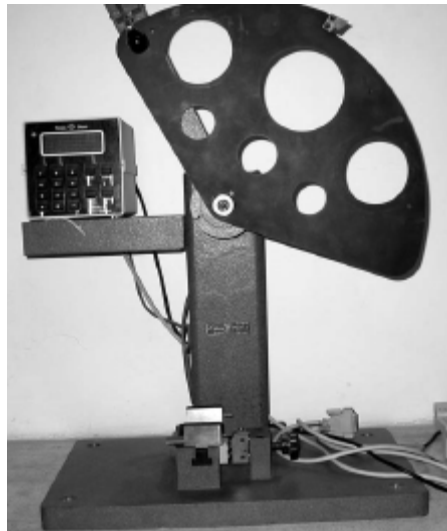
Figura 3.5 Máquina para pruebas de impactos, imagen tomada de publicación “Importancia de los ensayos mecánicos como herramienta de competitividad por Andrés F. Rigail, Plast universal”
