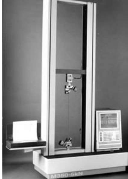
Figura 3.2 Máquina universal para pruebas de tensión, compresión, elongación y flexión (imagen tomada de Instron Limited Inc.).
