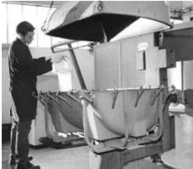
Figura 6.1 Molde de una nodriza horizontal. Llenado del molde en forma manual, imagen tomada de Rotoplas S.A. de C.V.
