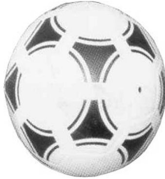
Figura 4.4 Geometría ideal esférica. Pelota de PVC (plastisol) realizada por el proceso de rotomoldeo.
