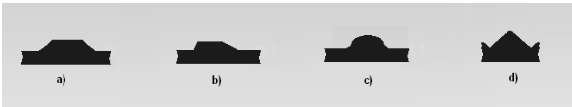
Figura 4.14 Formas de roscas. a) Rosca de uso general, b) Forma trapezoidal modificada, c) Rosca circular, d) Cuerda en V no se recomienda este tipo de rosca por los ángulos agudos que la conforman. [12].
