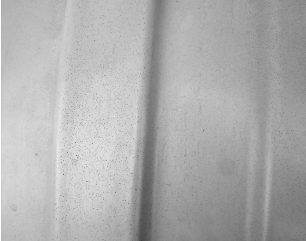
Figura 6.11 Defecto superficial en nodriza horizontal.
