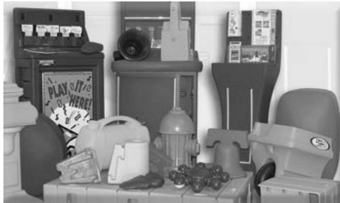
Figura 4.1 Piezas fabricadas por el proceso de rotomoldeo (imagen tomada de The Plastic Professionals Inc., rotacional molding).
