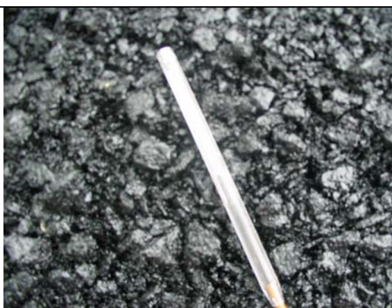
Concreto asfáltico de la base negra
