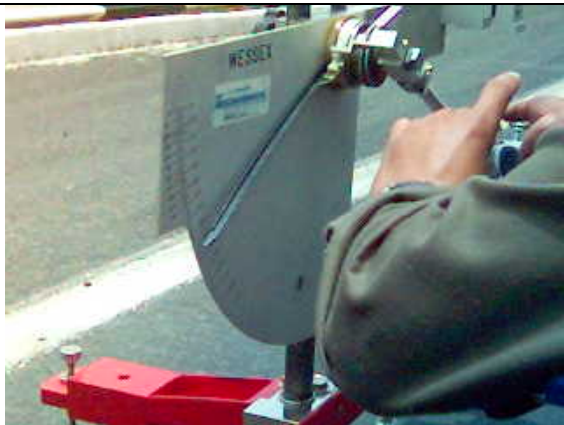
Prueba del péndulo británico para medir el coeficiente de fricción de la capa asfáltica
