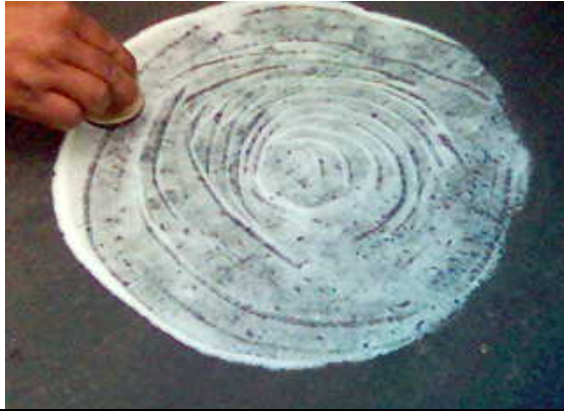
Clasificación de la textura de la capa de rodamiento con el método del círculo de arena.
