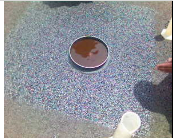
Pruebas de permeabilidad para definir la razón del riego de taponamiento para impermeabilizar la microcarpeta
