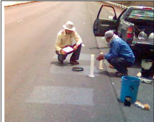
Pruebas de permeabilidad para definir la razón del riego de taponamiento para impermeabilizar la microcarpeta
