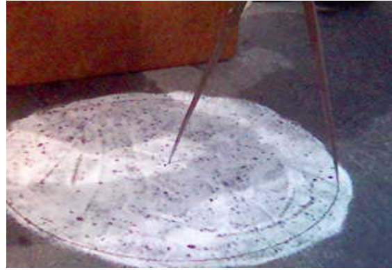
Clasificación de la textura de la capa de rodamiento con el método del círculo de arena.
