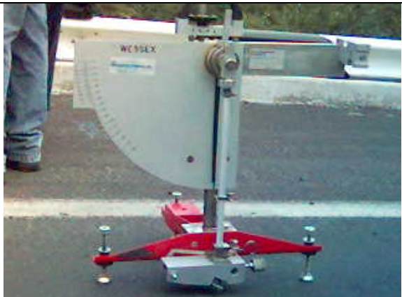
Prueba del péndulo británico para medir el coeficiente de fricción de la capa asfáltica
