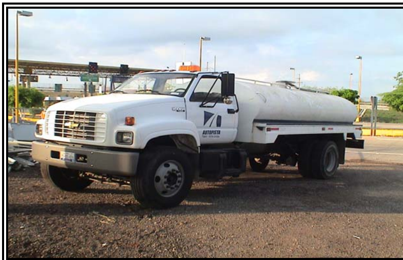
Figura 41. Pipa de 10,000 litros de almacenamiento de agua
