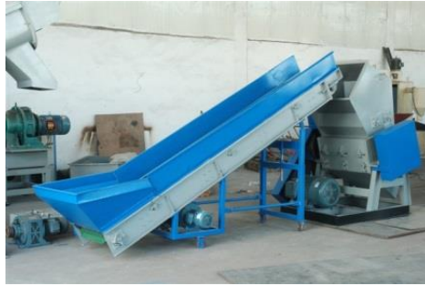
Fig.12 Cinta transportadora con molino ( http://www.maquinariadereciclaje.com ).
