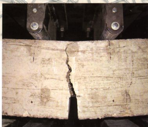
Ensayo de flexión sobre vigas de hormigón reforzado con fibras según la norma italiana UNI 11039 – Hormigón reforzado con fibras de acero.
