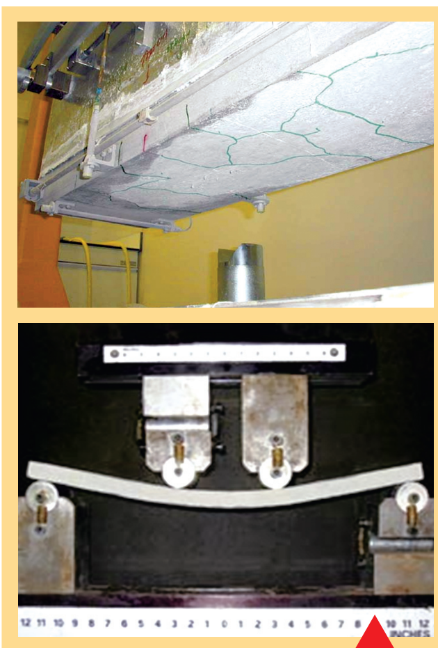
Imagen 3. Hormigón bajo flexión. Un refuerzo con alto contenido de fibras produce un hormigón “flexible”.
