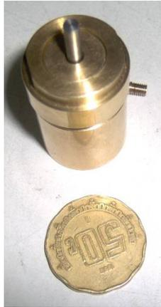
*Figura 29. Carcasa manufacturada en latón*
