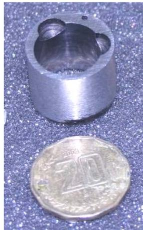
*Figura 19. Estator manufacturado de acero inoxidable*
