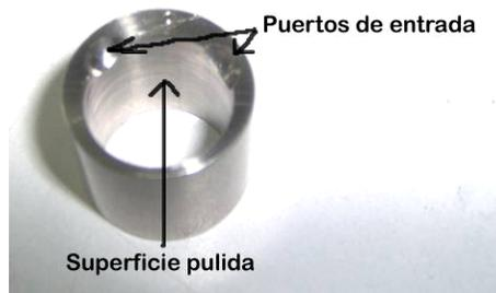
*Figura 45. Detalles de manufactura del estator*
