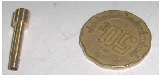
*Figura 30. Tubo auxiliar para conexión de racor*
